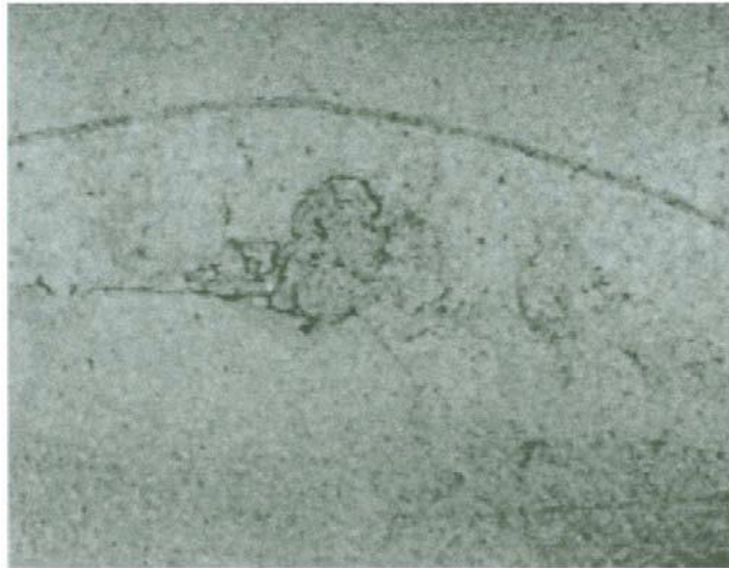
Gambar 5-6 cacat lipatan dingin (pada aluminium) disebabkan oleh residu cairan yang buruk
