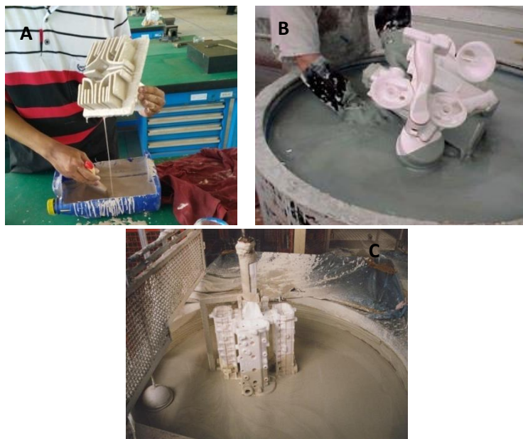
Gambar 4.1 Proses pelapisan pola EPS a) skala lab, b) industri (manual), c) industri (robotic)
