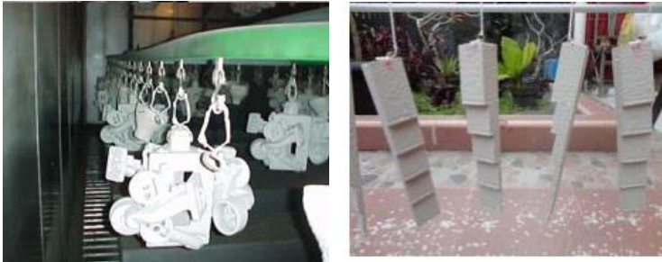
Gambar 4.2 proses pengeringan lapisan pola EPS
