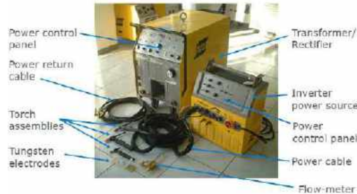
Gambar 7.2 peralatan utama pengelasan TIG (TWI, 2018)
