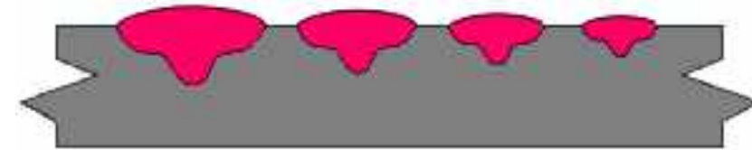
Gambar 5.17 Pengaruh kecepatan pengelasan. Saat kecepatan pengelasan meningkat, akan mengurangi kedalaman penetrasi dan lebar las, undercut (TWI, 2018)
