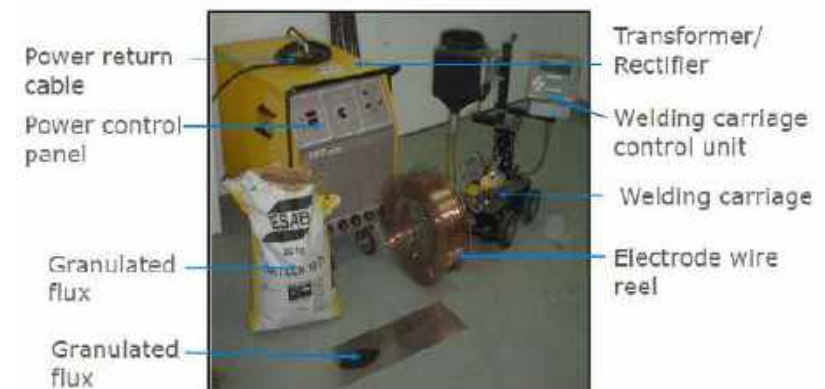
Gambar 6.3 komponen utama las SAW (TWI, 2018)
