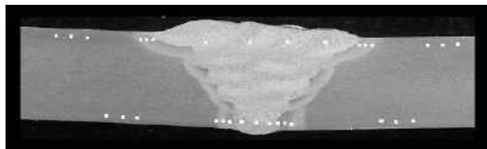
Gambar 11.16 pemeriksaan nilai kekerasan metode Vickers (TWI, 2018)
