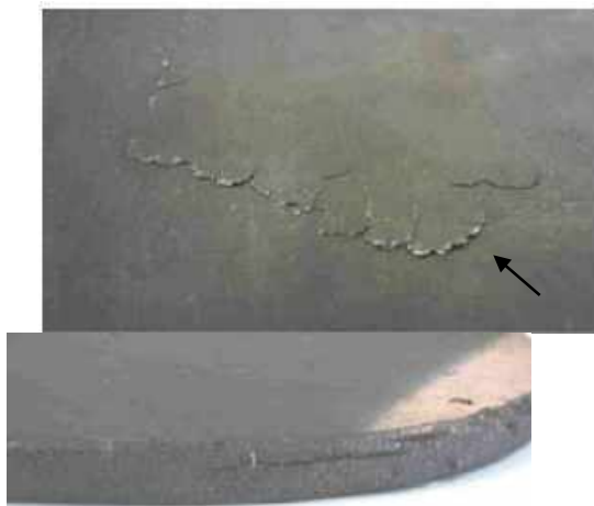
Gambar 3.3 a) cacat cold laps pada pelat baja dan b) cacat laminasi (TWI, 2018)
