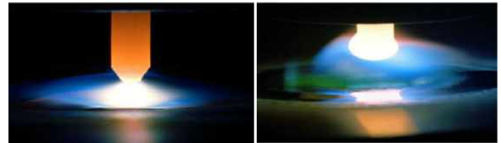
Gambar 7.5 Busur listrik a) Arus DC dan b) arus AC (TWI, 2018)
