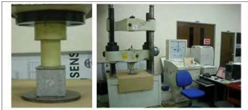
Gambar 3.10 Pengujian Kekuatan Tekan dengan menghasilkan nilai Modulus Elastisitas dan rasio Poisson dengan komputerisasi
