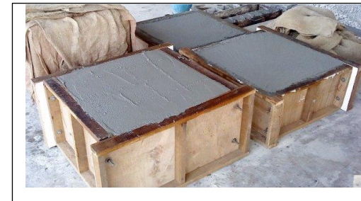
Gambar 3.8 Foamed concrete dicetak dengan ukuran sesuai dengan desain
