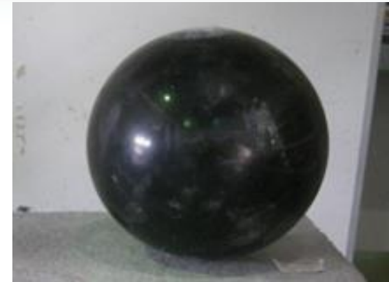
Gambar 3.13 Model obyek penumbuk berbentuk bola yang tidak dapat berdeformasi yang mewakili penumbuk tumpul yang digunakan dalam penyelidikan ini.
