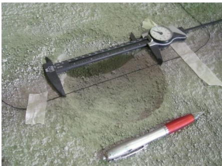
Gambar 4.5 Pengukuran diameter dan kedalaman cekungan kawah
