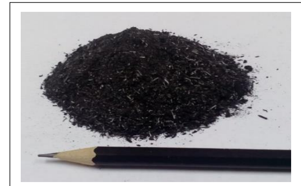
Gambar 3.1 RHA dibakar tanpa kendali \pm 700^{\circ}\text{C} dalam waktu \pm 6 jam
