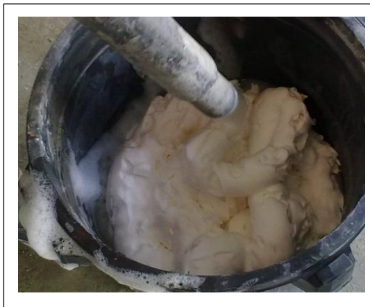
Gambar 3.5 Busa yang dihasilkan dari generator busa
