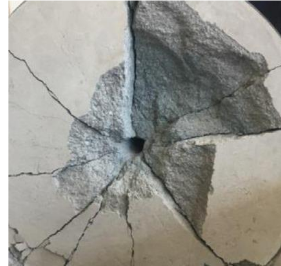
Gambar 1.3 Kerusakan beton kaku dan bertulang akibat beban tumbukan proyektil tajam (X. Zhang, Wu, Zhang, & Huang, 2020)
