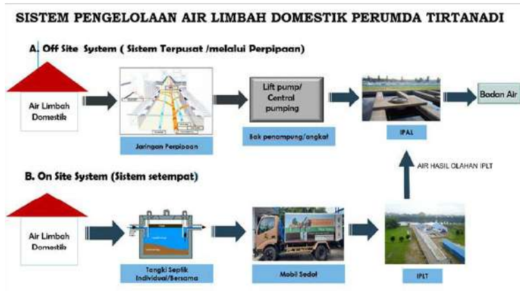
Gambar2.3 Pengolahan Limbah Domestik terintegrasi IPLT & IPAL
